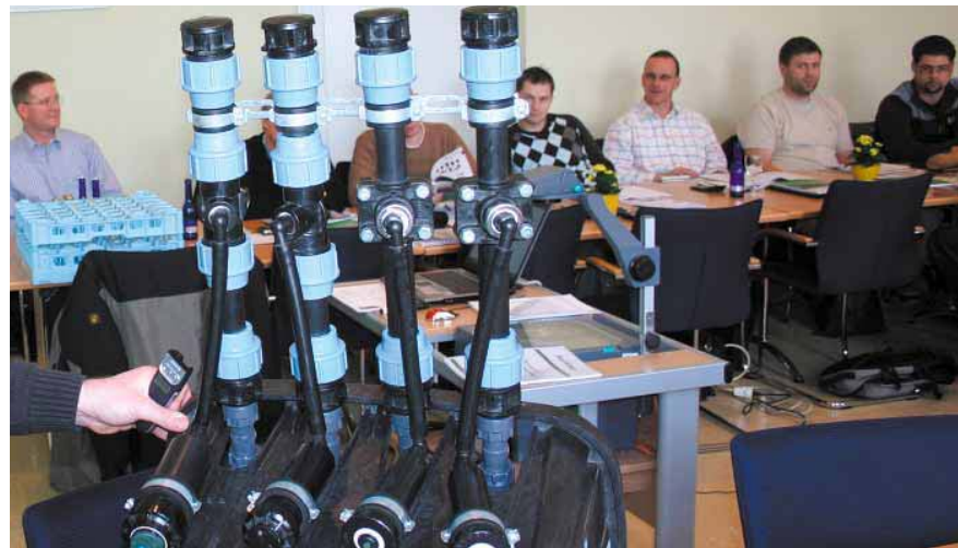
Im Rahmen der Schulung wird auch die Technik des neuen komplett vormontierten Ventilkastens erläutert. | Fotos: E. Bauer.
